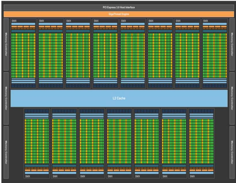
図 4・1 Kepler GK110 チップ全体の模式図 (NVIDIA 社提供)
