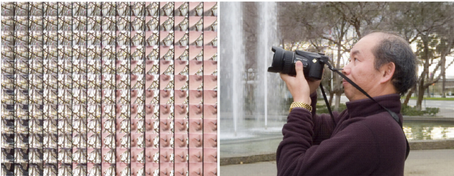
図 3・5 プレノプティック 2.0 のカメラにより撮影した画像（一部切り出し）と、それにより手前の人物にリフォーカシングした例 5)
