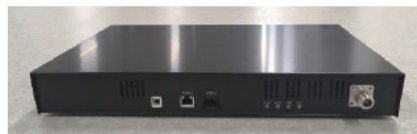
図 2・9 京大が開発した IEEE 802.22 準拠の小型無線機 17)
