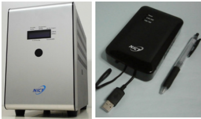
図 2・11 NICT が開発した TDD/FDD デュアルモード対応 TVWS LTE 無線機 20)
