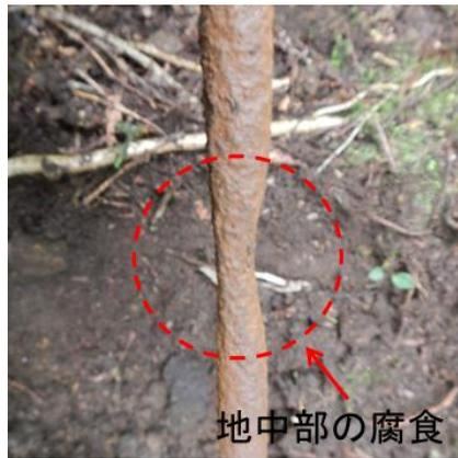
図 9・21 炭素鋼材の地中部腐食の事例
