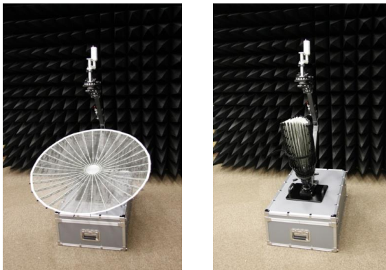
図 1・17 展開型メッシュ反射鏡アンテナの開発事例 (左: 展開時, 右: 収納時)
