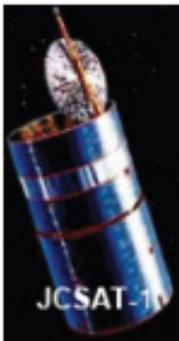
図 1・1 JCSAT-1 衛星 (スピン安定型)
