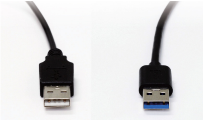
図 2・5 USB Type-A コネクタ (左が USB 1.0/USB 2.0 対応, 右が USB 3.0 対応)
