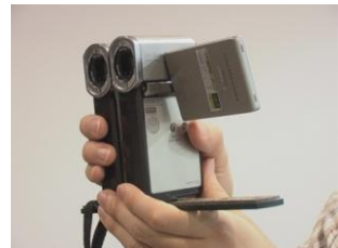
図2・99 32mm視差の試作3Dカメラ
