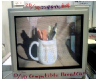
図 2・109 2重像にならないコンパチブル立体放送
