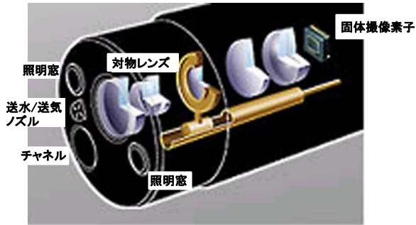
図 2・94 電子内視鏡先端部
