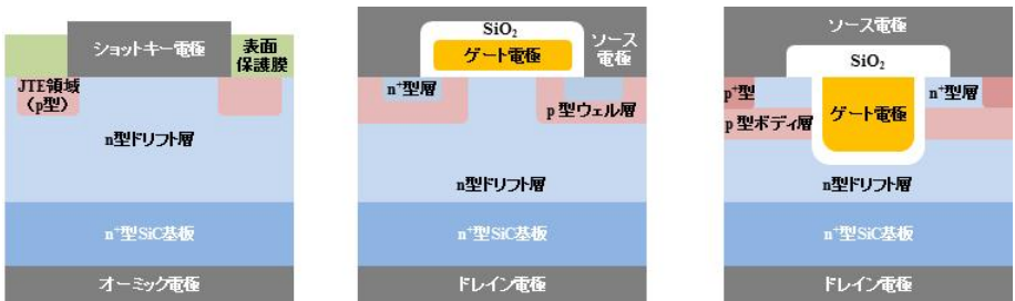
図 2・1 SiC デバイス模式図 (a) SiC-SBD, (b) SiC-DMOSFET, (c) トレンチ構造 SiC-MOSFET
