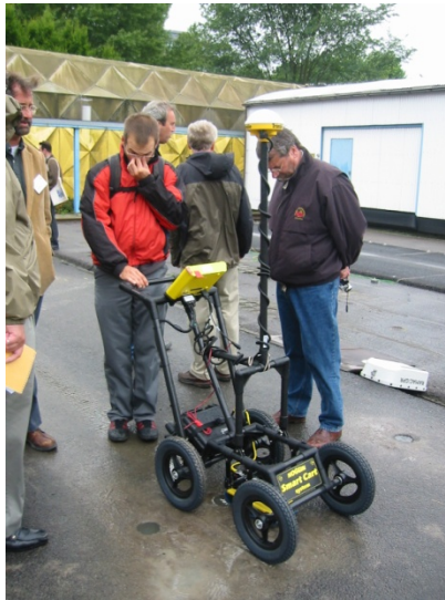
図 3・16 地中レーダ (GPR) 装置
