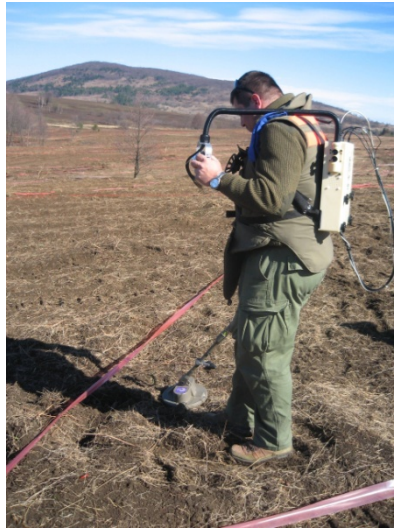
図 3・18 GPR による地雷検知 (東北大学 ALIS)
