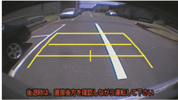
図 3・7 バックモニタの表示画面例 (出典：トヨタ自動車ホームページ)
