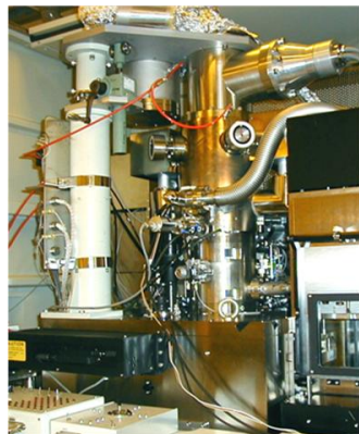
図 1・13 電子ビーム露光装置の概念図。左図はプロセスフローも示している。右図は装置外観写真
