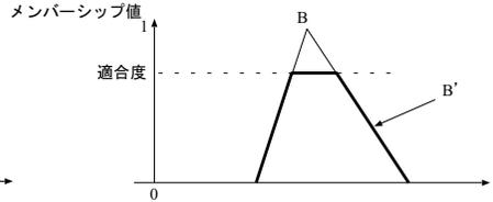
図 2-17 マムダニ推論 (後件部変形)
