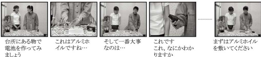
図2・5 机上作業シーン映像の実時間編集(話者の手の位置と発話内容に基づいて最適なカメラを選択)
