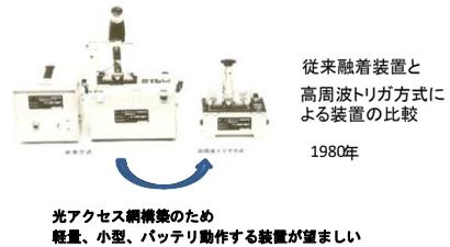
図 5・2 融着接続装置小型化、バッテリー駆動化
