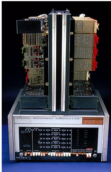
図 3・4 初期型 PDP-8 の筐体
