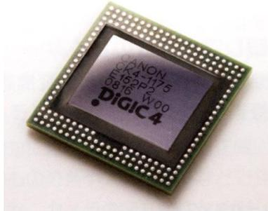
図 2・55 デジタルカメラ専用画像処理プロセッサ
