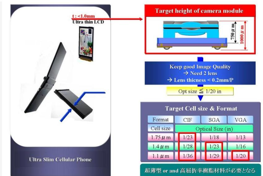
図 2・80 超薄型カメラモジュール
