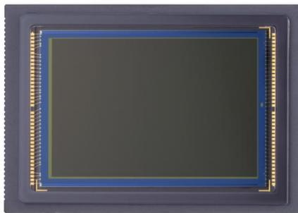
図 2・54 CMOS センサ外観
