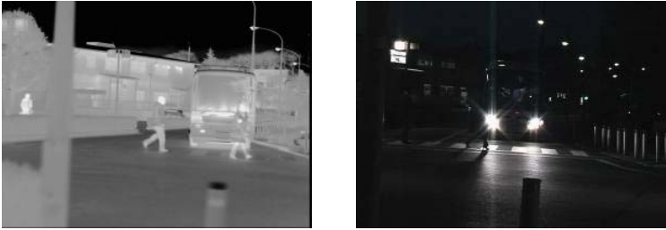
図 3・17 ヘッドライトの影響が少ない赤外線（左）vs. 可視（右）
