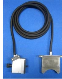
図 3・25 フェーズドアレイ探触子
