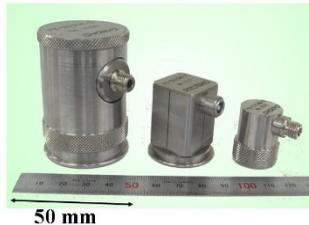
図 3・17 垂直探触子（外観写真）
