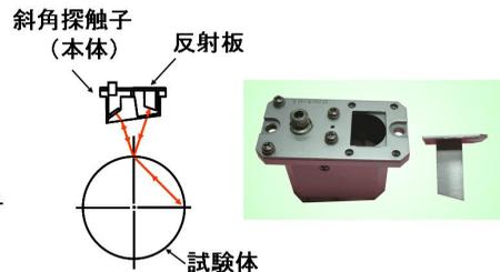
図 3・23 反射板付き斜角探触子
