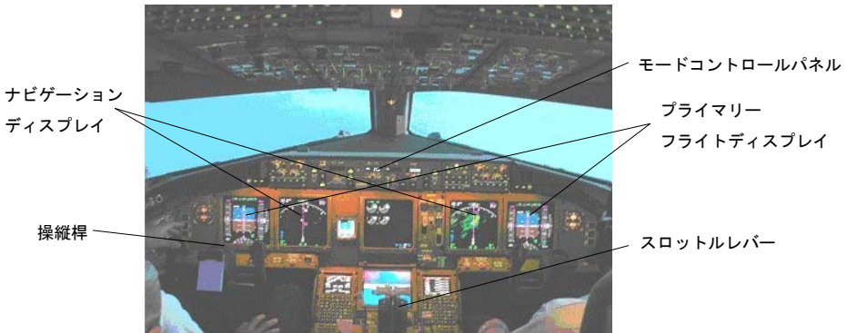
図 1・5 B777 の自動操縦システムと計器類
